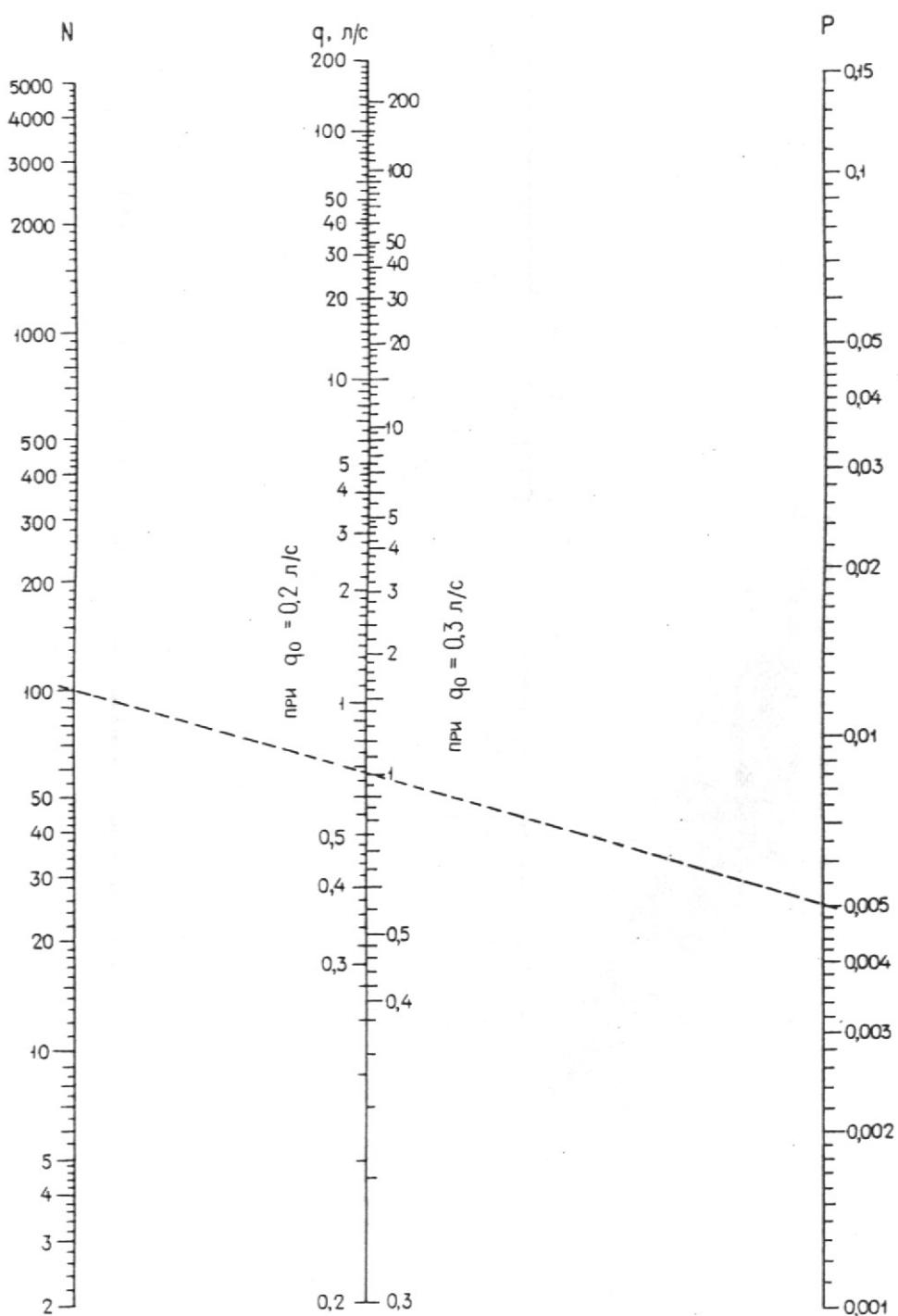
Черт. 2. Номограмма для определения секундных расходов воды  $q$  при  $q(0)=0,2$  и  $0,3 \text{ л}/\text{с}$  и  $P \leq 0,15$
