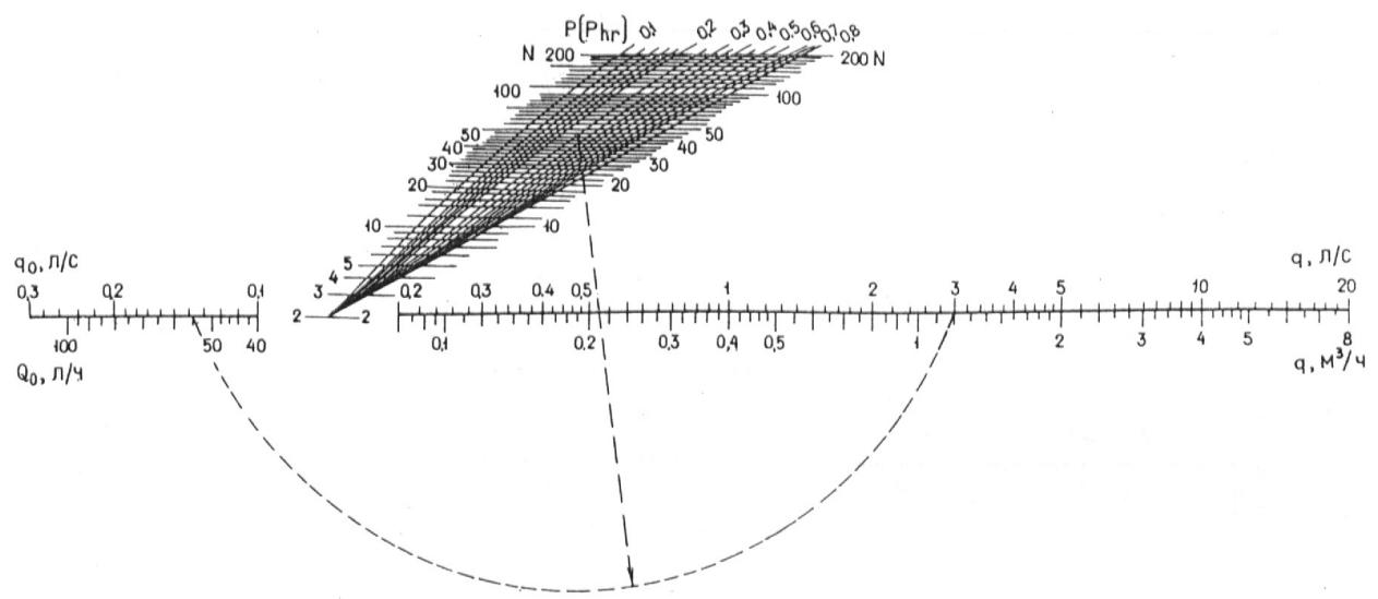
Черт. 3. Номограмма для определения секундных и часовых расходов воды  $q$  при  $q(0) \leq 0,3 \text{ л}/\text{с}$ ,  $N \leq 200$  и  $P > 0,1$
