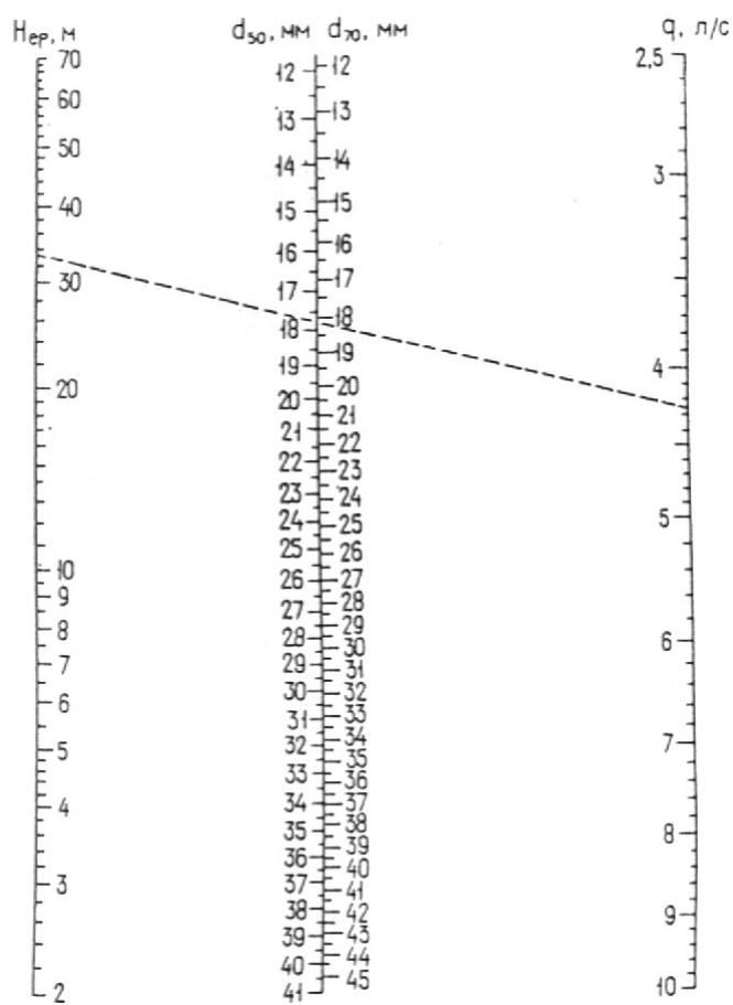
Черт. 5. Номограмма для определения диаметров отверстий диафрагм,
