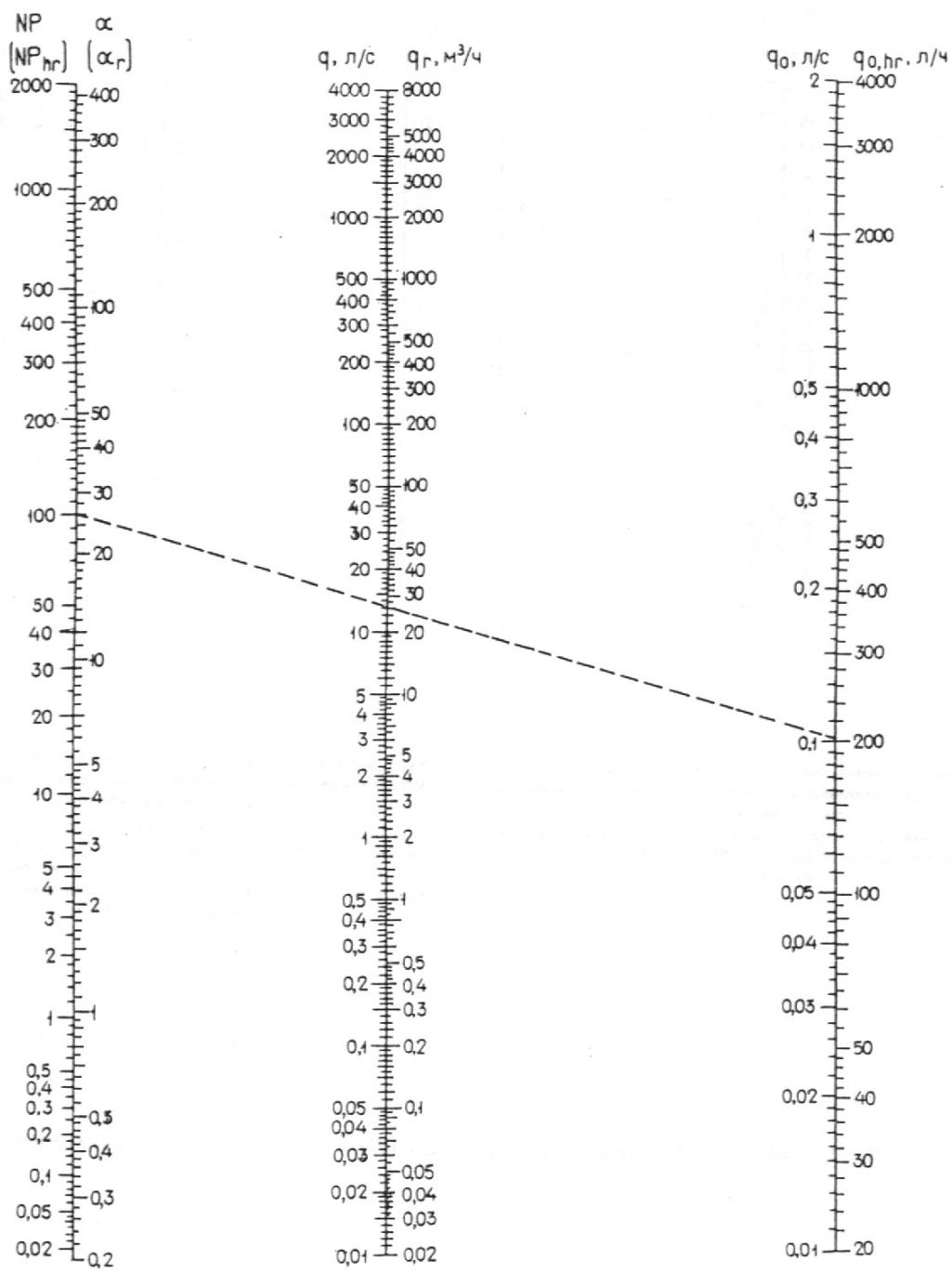
Черт. 4. Номограмма для определения секундных и часовых расходов воды в зависимости от  $NP$  ( $NPhr$ ) при различных значениях  $q(0)$ ,  $l/c$ , и  $q(0,hhr)$ ,  $l/h$
